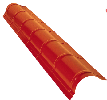
KUMER HARJAPLEKK 180 x 180, L = 1 930 mm soovitatame kivikujuga profiilplekist katustele kaldega ≤ 1:2
